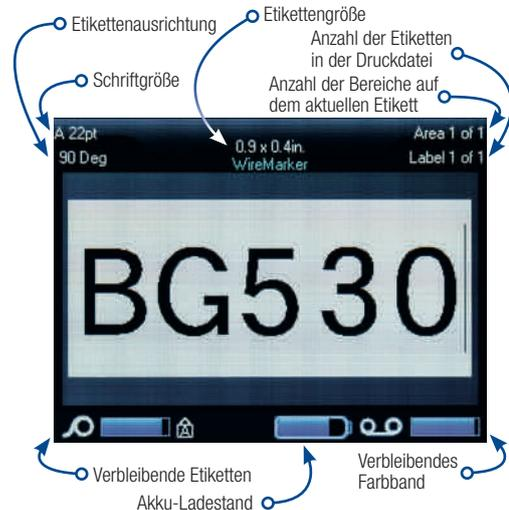
Alle BMP61 Etiketten und Farbbänder werden vom Drucker automatisch erkannt und kalibriert. Besonders praktisch: Auf dem Farb-Touchscreen des Druckers wird angezeigt, welches Etikettenmaterial gerade eingelegt ist, wie viele Etiketten noch verfügbar sind und wie viel Druckfarbe und Akkuleistung verbleiben.
