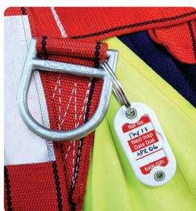
Die gesetzlich vorgeschriebenen Prüfungen des Sicherheitsgeschirrs werden vor dessen Benutzung von autorisiertem Personal (einer befugten Person\*) ausgeführt. Wenn das Sicherheitsgeschirr die Prüfung bestanden hat, wird das Einsteckschild in den Nanotag™-Halter gesteckt, um anzuzeigen, dass das Sicherheitsgeschirr benutzt werden darf. Der Fälligkeitstermin der nächsten Prüfung wird auf dem Nanotag™-Einsteckschild vermerkt.
